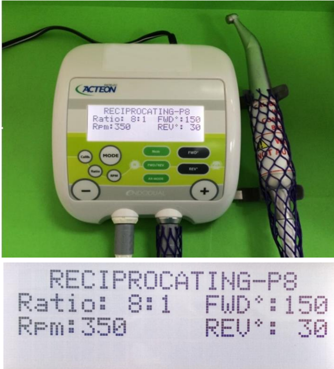
Şekil 3. 6 Satelec Endo Dual motor ve kullanım ayarları
