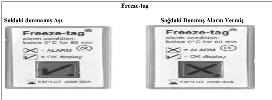
Şekil 2.4.9.1. 30 Günlük Eletronik Buz Dolabı ısı Kayıt Cihazı (WHO, 2008; CDC, 2016)
