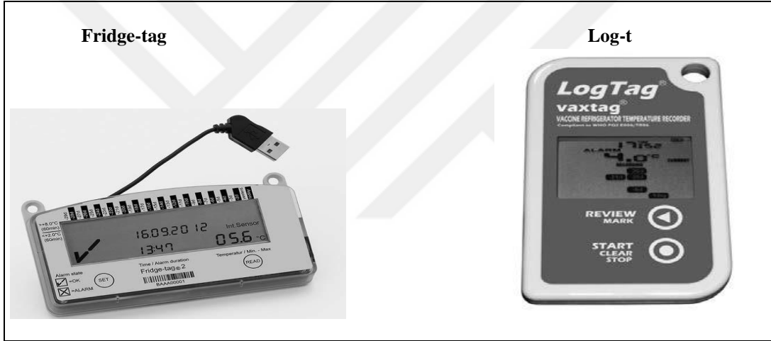
Şekil 2.4.9.1. 30 Günlük Eletronik Buz Dolabı ısı Kayıt Cihazı (WHO, 2008; CDC, 2016)
