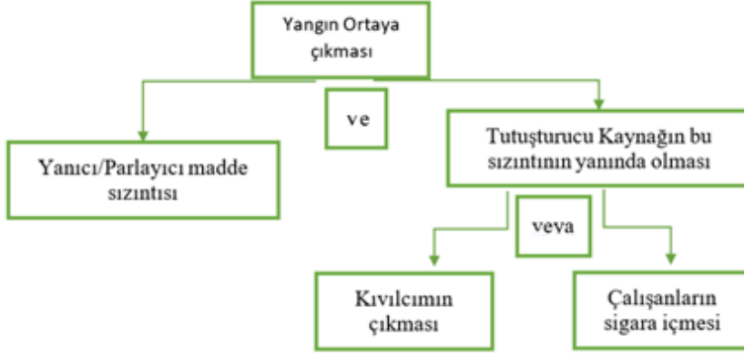
Şekil 1.5. FTA “ Yangın ortaya çıkması” şemasının örneği (Şardan, 2005)
