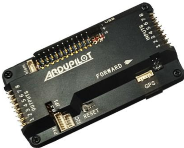
Şekil 3.5. APM uçuş kontrol kartı
