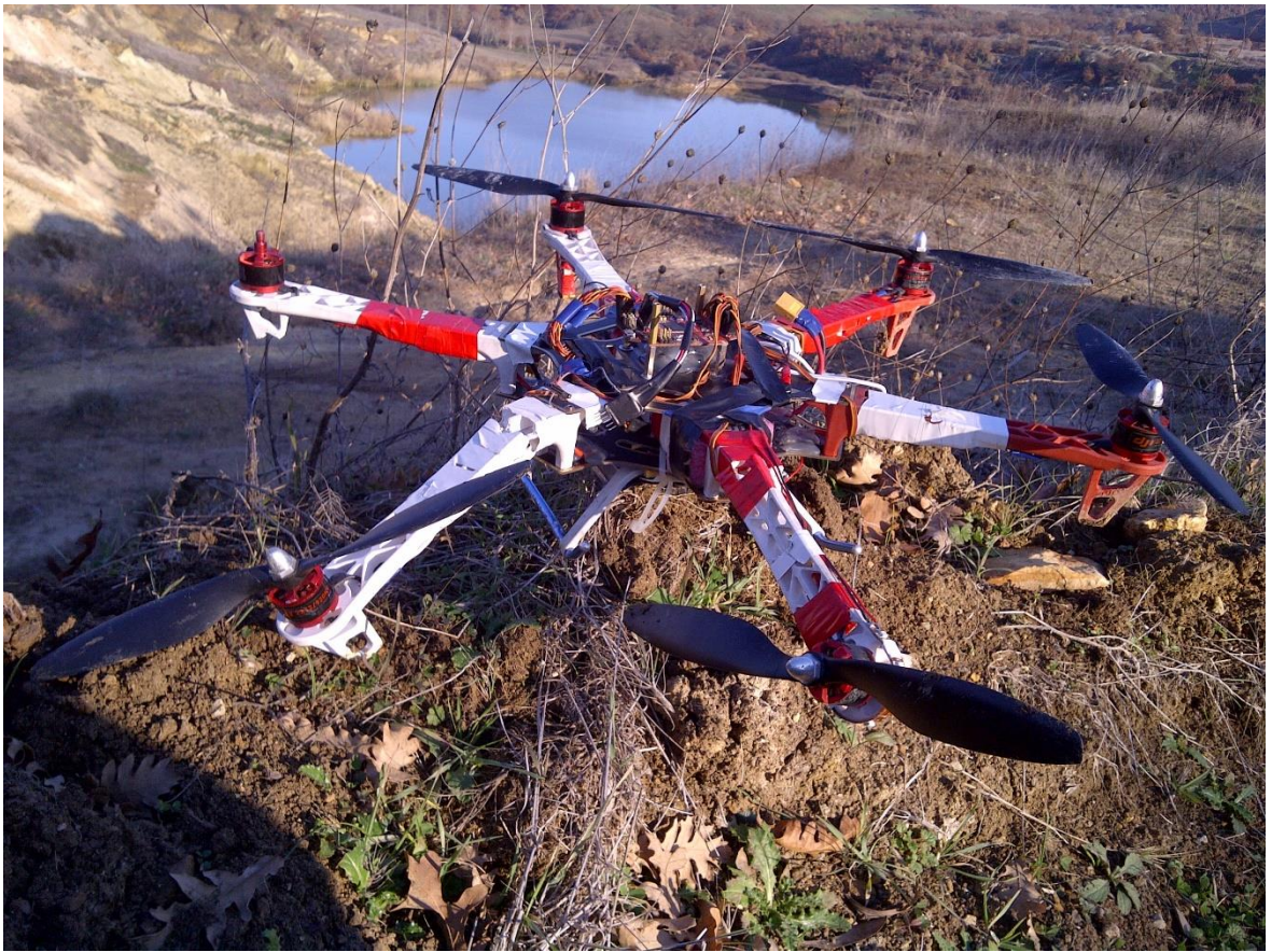
Şekil 4.3. Düşme sonrası İHA'da meydana gelen hasar
