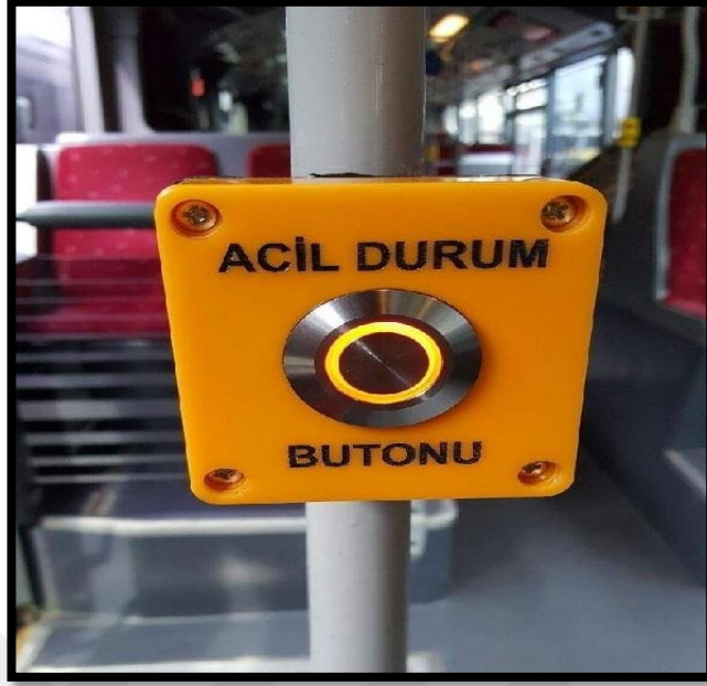
Şekil 3.12:Acil durum butonu örneği
