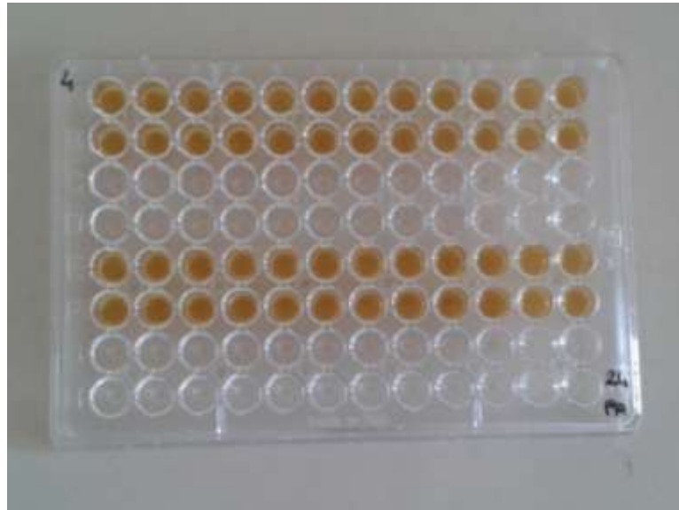
Şekil 8. Mikroorganizma süspansiyonları eklenmiş 96 kuyucuklu steril U tabanlı polistren mikropklak
