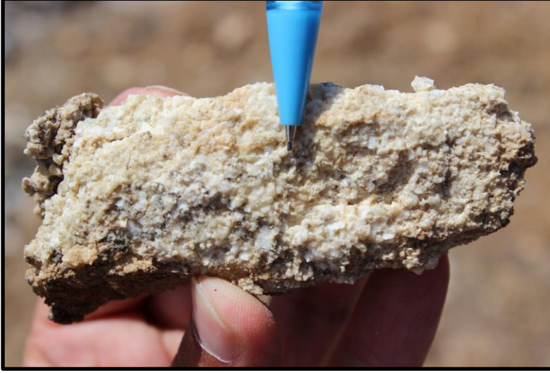
Şekil 4.7. Bozalan Formasyonu'ndaki rekristalize kireçtaşında gözlenen şeker dokusu örneği
