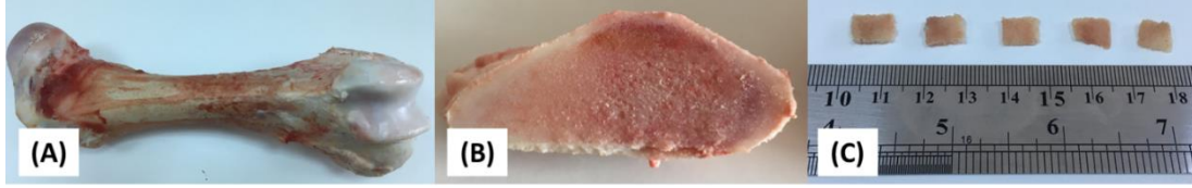
Şekil 9. Ham kemik dokusunun uygun boyutlarda kesilme aşamaları (A) Sığır tibiası (B) Ayrılmış trabeküler kemik (C) Uygun boyutlara getirilmiş trabeküler kemikler
