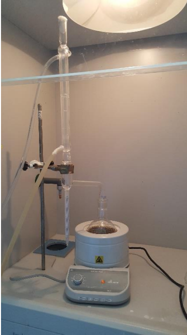
Şekil 3. Toluen yöntemi ile nem analiz düzeneği
