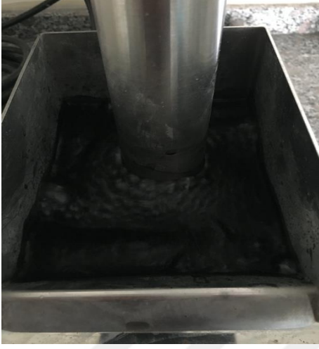
Őekil 19. Saf suda yapılan linyit flotasyonu
