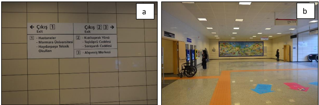
Şekil 5.14: Çıkışlarda yer almayan yönlendirici asansör bilgisi (a) ve asansör bilgilendirme tabelasının yanlış uygulanması (b)
