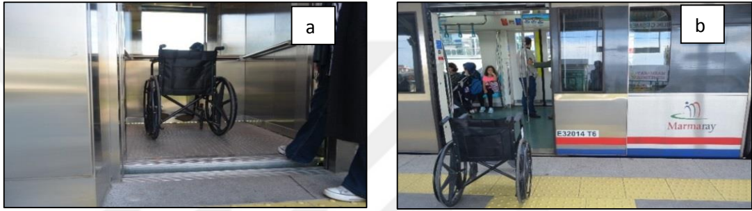
Şekil 5.15: Asansör-Kaldırım arasında yönlendirici (a) ve engelli vagonuna standart dışı boşluk örneği bilgi eksikliği (b)
