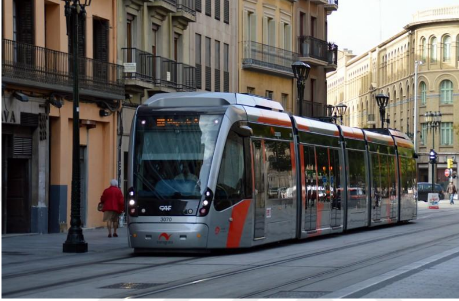
Şekil 3.12: CAF firmasının Zaragoza'daki Katenersiz Çözümü
