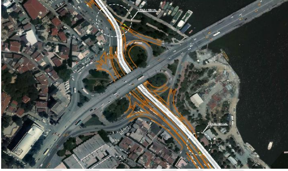
Şekil 6.2: Unkapanı-Şişhane Karayolu Bağlantısı ile Tramvay Hattı İlişkisi
