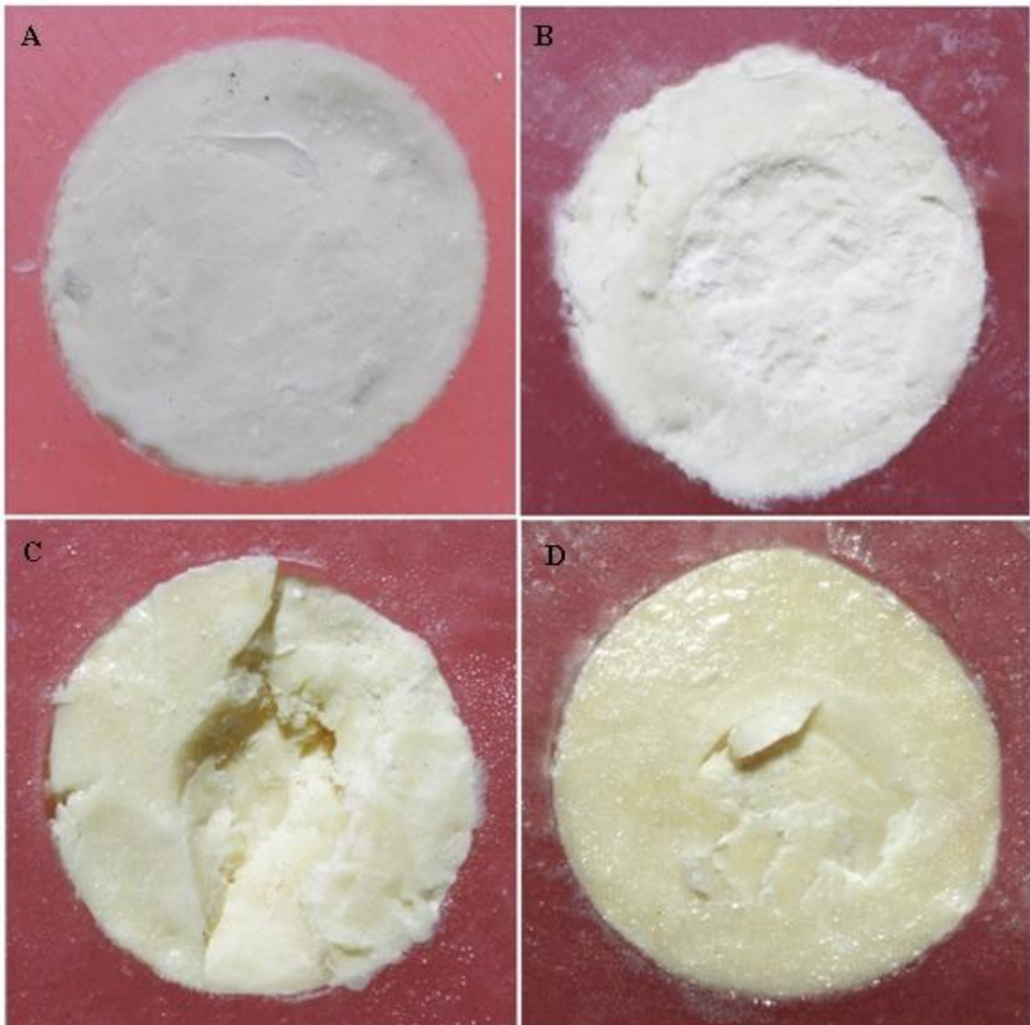
Şekil 4.5: Kopma tiplerine ait stereomikroskop görüntüleri ( A: Adeziv tip kopma, B: 12 dakika grubunda meydana gelmiş Biodentine'de yüzeysel koheziv tip kopma, C: 96 saat grubunda meydana gelmiş Biodentine içerisinde derin koheziv tip kopma ve D: Karışık tip kopma).
