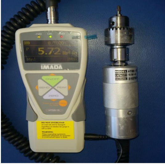
Şekil 3.22. Çalışmada kullanılan geri tork cihazı (IMADA, Northbrook, IL 60062 USA)
