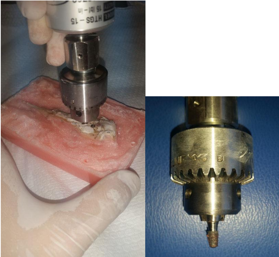
Şekil 3.22. Geri tork cihazının implant abutmentlarına tutturulması ve implantların çıkartılması.
