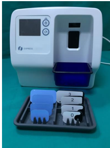
Şekil 3.14 Fosfor plak ve tarayıcısı Instrumentarium Express Origo Instrumentarium, Finland Dental,Finland
