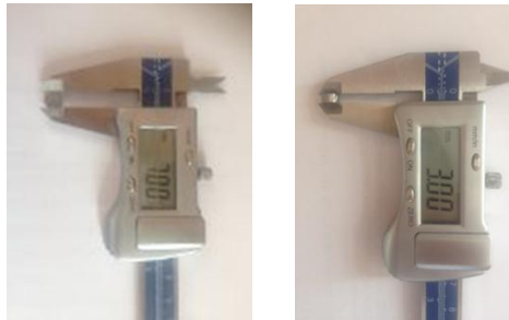
Şekil 3.2. Hazırlanan Titanyum Örnek Boyutları
