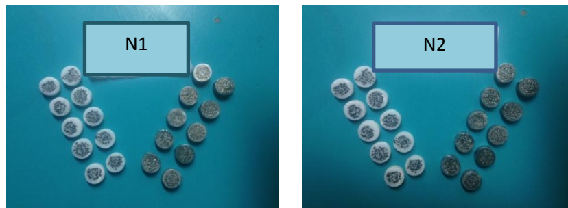
Şekil 3.8. Nd-YAG Lazer İle Şartlandırılmış Zirkonya ve Titanyum Esaslı Örnekler
