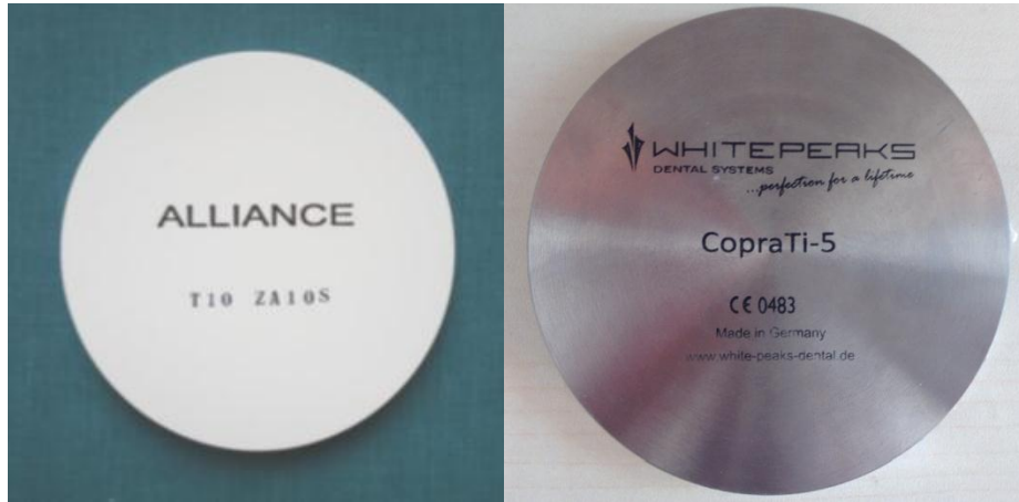
Şekil 3.1. Zirkonya ve Titanyum Örneklerin Hazırlanmış Bloklar
