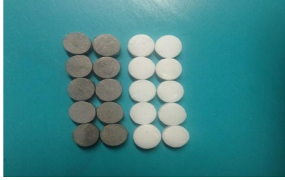
Şekil 3.6. Kumlama Yapılmış Zirkonyave Titanyum Örnekler
