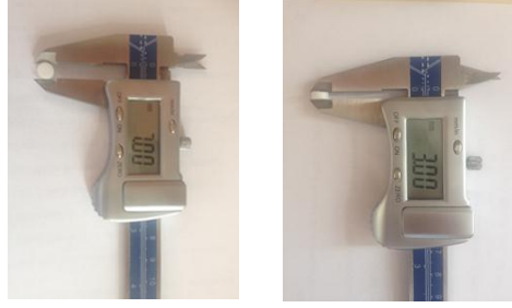
Şekil 3.3. Sinterizasyondan Sonra Zirkonya Örnek Boyutları
