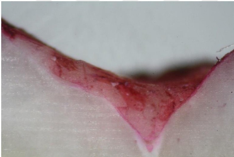
Şekil 4.22: Glass Seal grubuna ait mikrosızıntı örneği.
