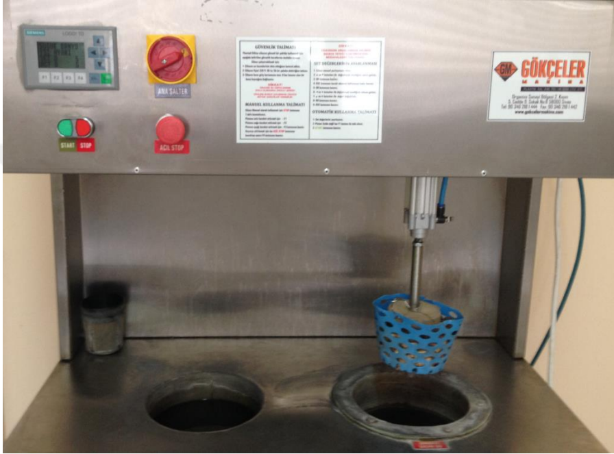
Şekil 3.14: Çalışmada kullanılan termal siklus cihazı.
