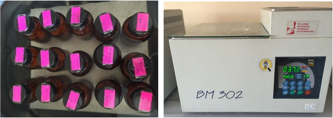
Şekil 3.10. Örneklerin gıdaları taklit eden sıvıların içinde ve su banyosunda bekletilmesi
