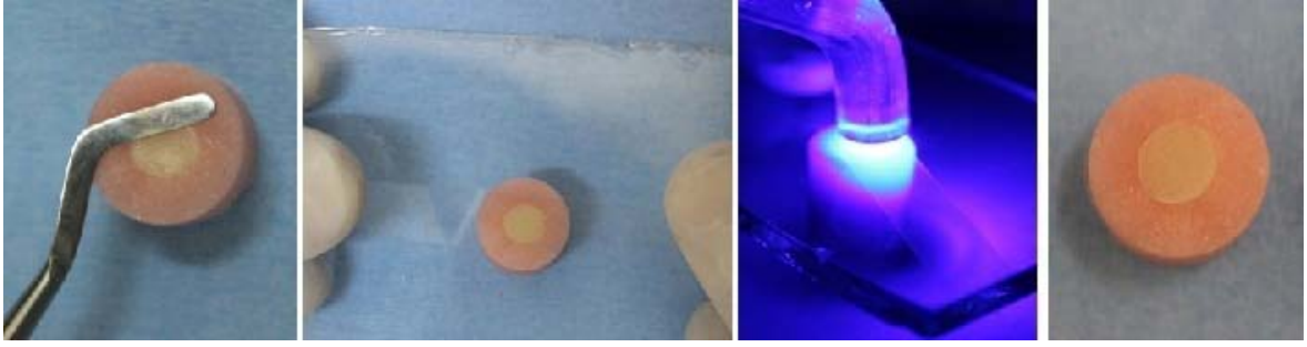
Şekil 3.3. Bloklar üzerindeki kavitelere kompozit yerleştirilmesi ve polimerizasyon işlemi
