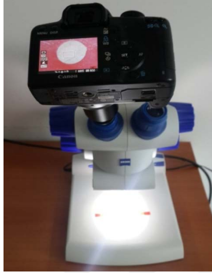
Şekil 3.13. Stereomikroskop ile kırık tiplerine bakılması
