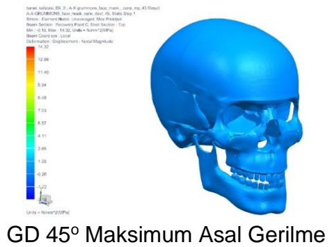
Şekil 4.8 GD 0° - 45° modelleri için tüm kafa-yüz sisteminde görülen minimum asal gerilme değerleri.
