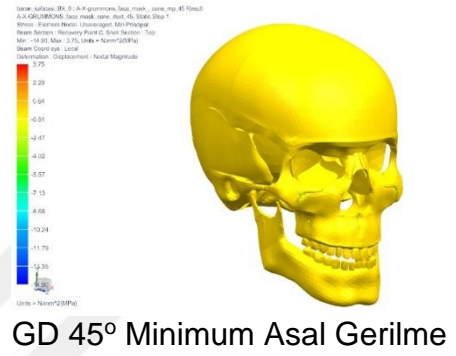
Şekil 4.7 GD 0° - 45° modelleri için tüm kafa-yüz sisteminde görülen minimum asal gerilme değerleri.
