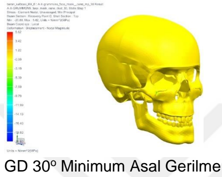
Şekil 4.7 GD 0° - 45° modelleri için tüm kafa-yüz sisteminde görülen minimum asal gerilme değerleri.
