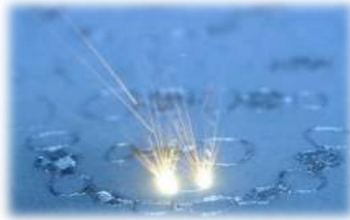
Şekil 2.14: Lazer ışınının toz alaşımına uygulanması
