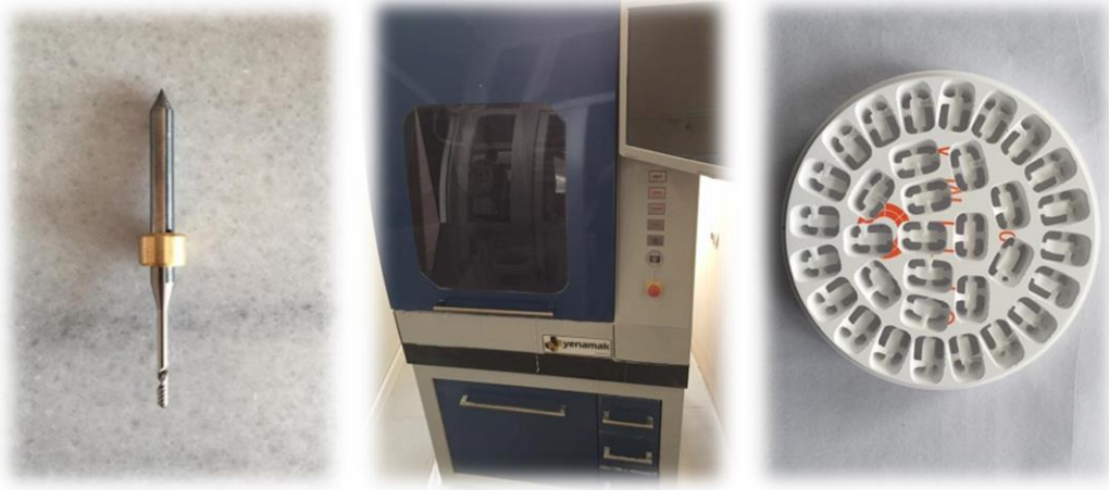
Şekil 3.3, 3.4 ve 3.5: CAM ünitesi kalibrasyon frezi, CAM ünitesi ve üretim sonrası kazınan zirkonya blok
