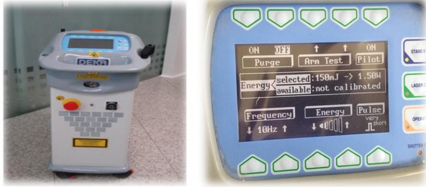
Şekil 3.12 ve 3.13: Er-YAG lazer cihazı ve kullanılan parametreler
