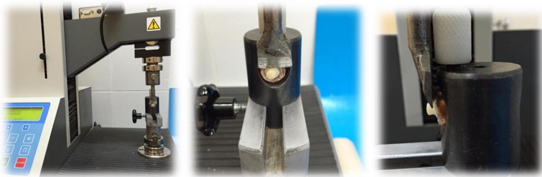
Şekil 3.17, 3.18 ve 3.19: Universal Test Cihazı ve makaslama testinin uygulanışı
