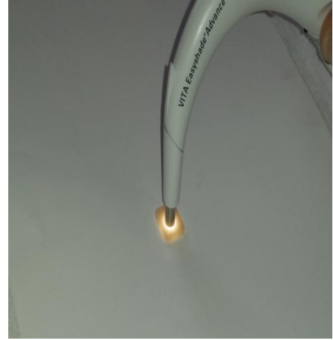
Şekil 3.11. Vita Easyshade kalibrasyon işlemi. Şekil 3.12. Vita Easyshade ile renk ölçüm işlemi.
