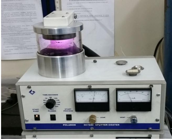
Şekil 3.17. Splutter Coater cihazı ile altın-paladyum kaplaması.
