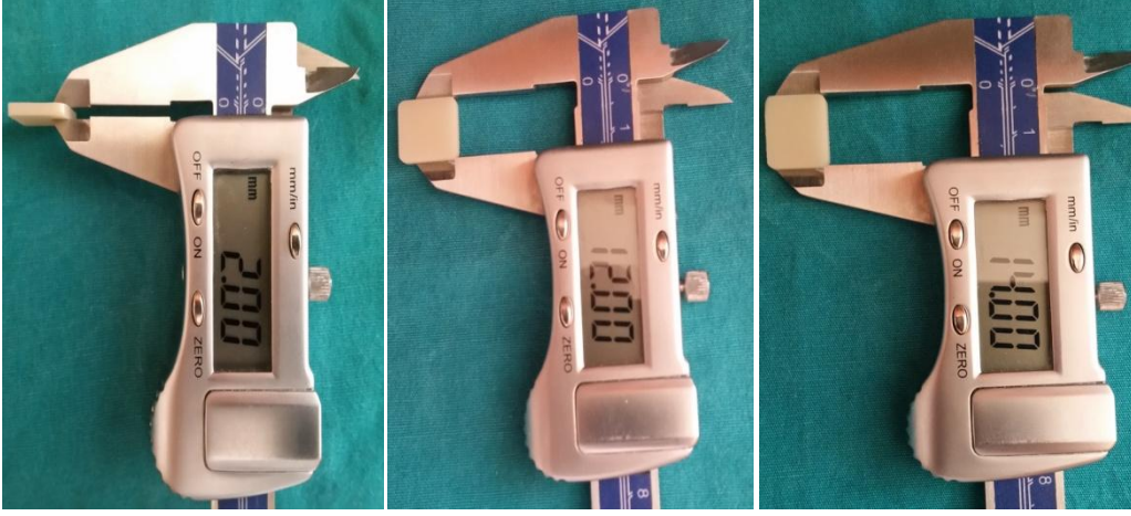
Şekil 3.6. Dijital kumpas ile örnek boyutlarının ölçümü.
