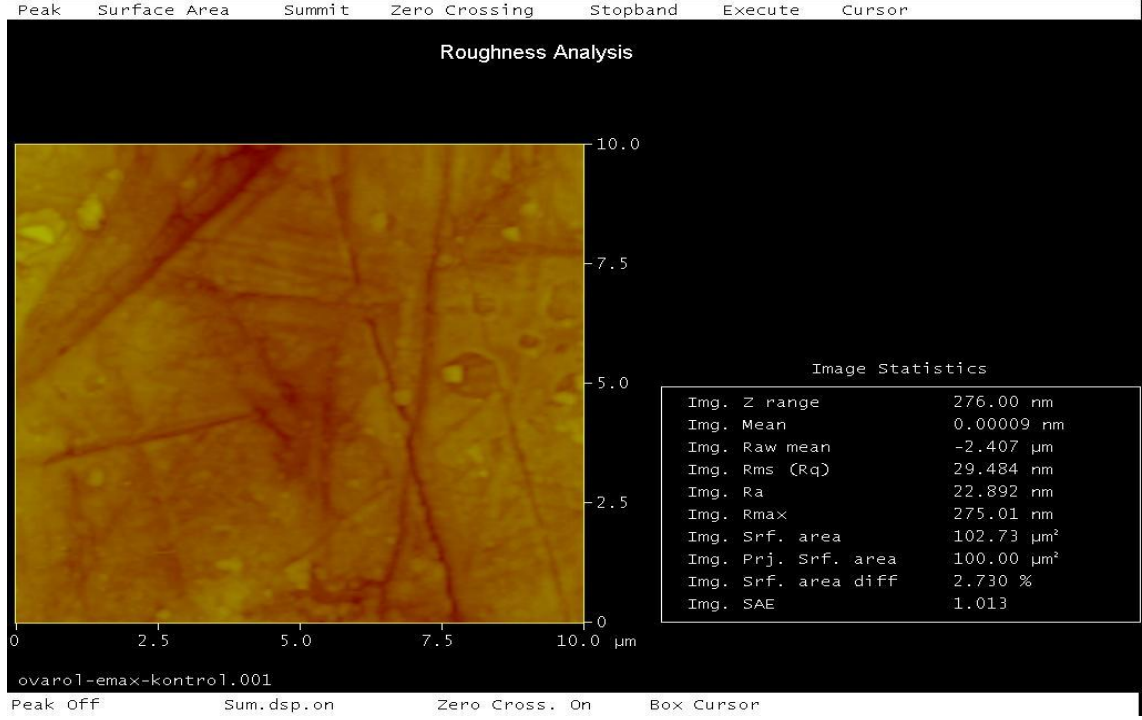
Şekil 4.23. IPS e.max Kontrol gurubunun Ra değeri: 22,892nm
