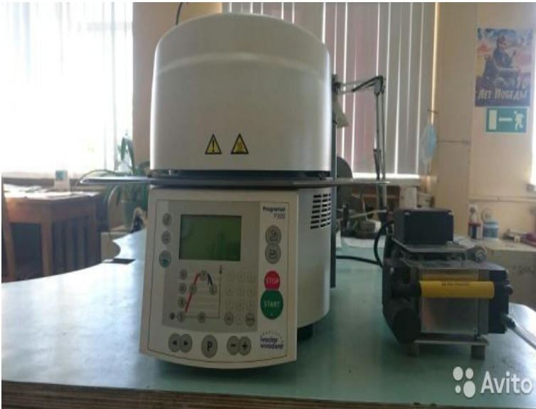
Şekil 3.7. Kristalizasyon işleminin yapıldığı Programat P300 porselen fırını.
