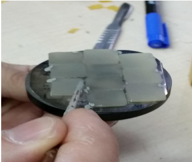
Şekil 3.18. Fırça yardımıyla gümüş boyanın uygulanması.
