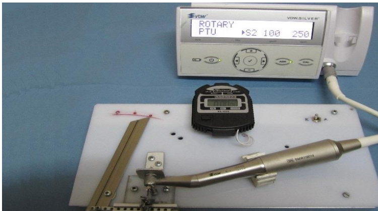
Őekil 3.9: Fleksural yorgunluęun deęerlendirilmesi için kullanılan test düzeneęi.
