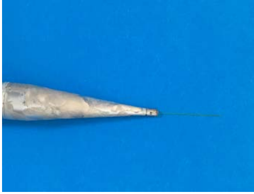
Şekil 3.12. Nd:YAG lazere ait 200 µm'lik fiber optik uç.
