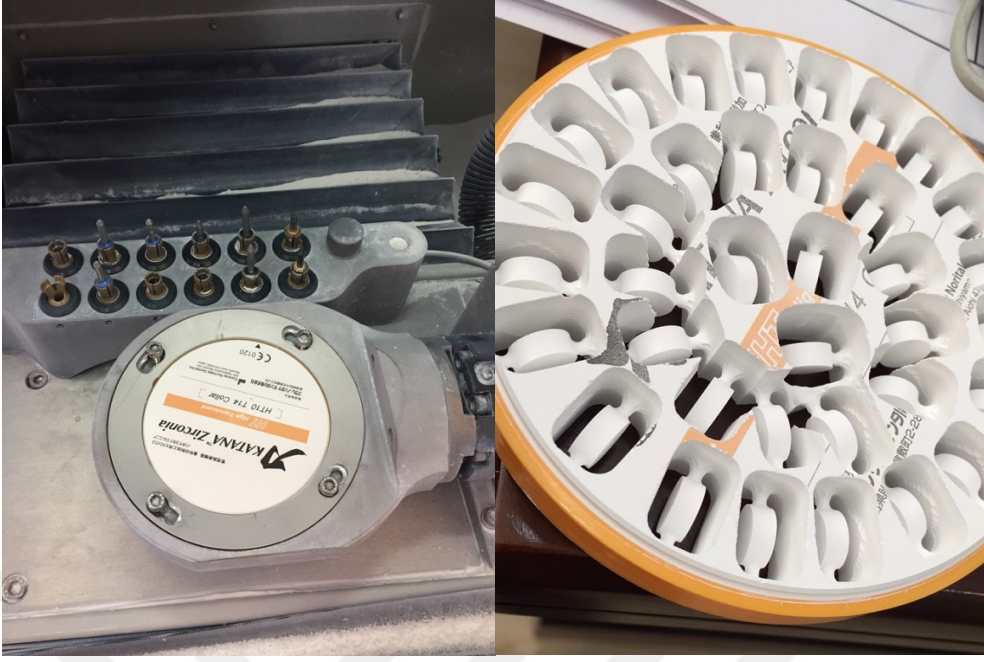
Şekil 3.9: Monolitik Zirkonyum Üretimi.
