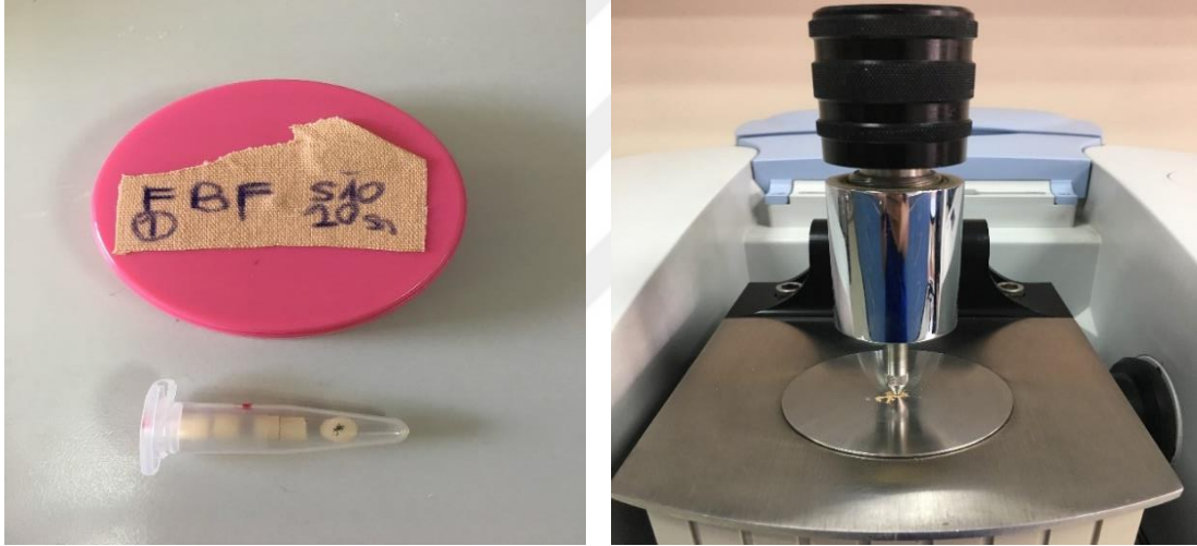
Şekil 3. 15 Toz haline getirilen örneğin ATR kristaline yerleştirilmesi ve ölçümü tamamlanan örnekler.
