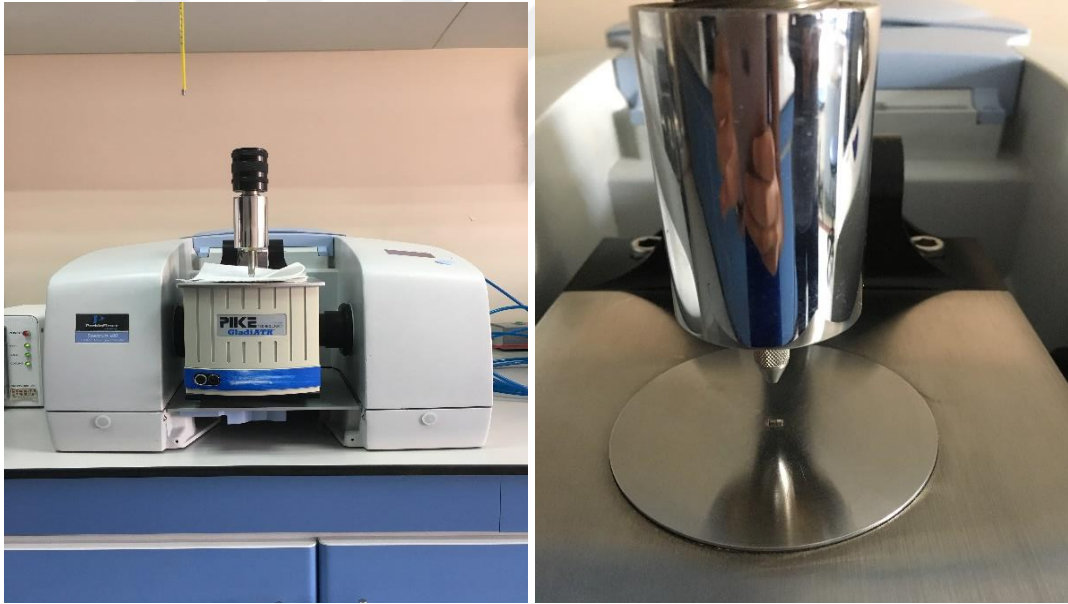
Şekil 3. 12 FTIR-ATR cihazı ve cihazın ATR kristali.
