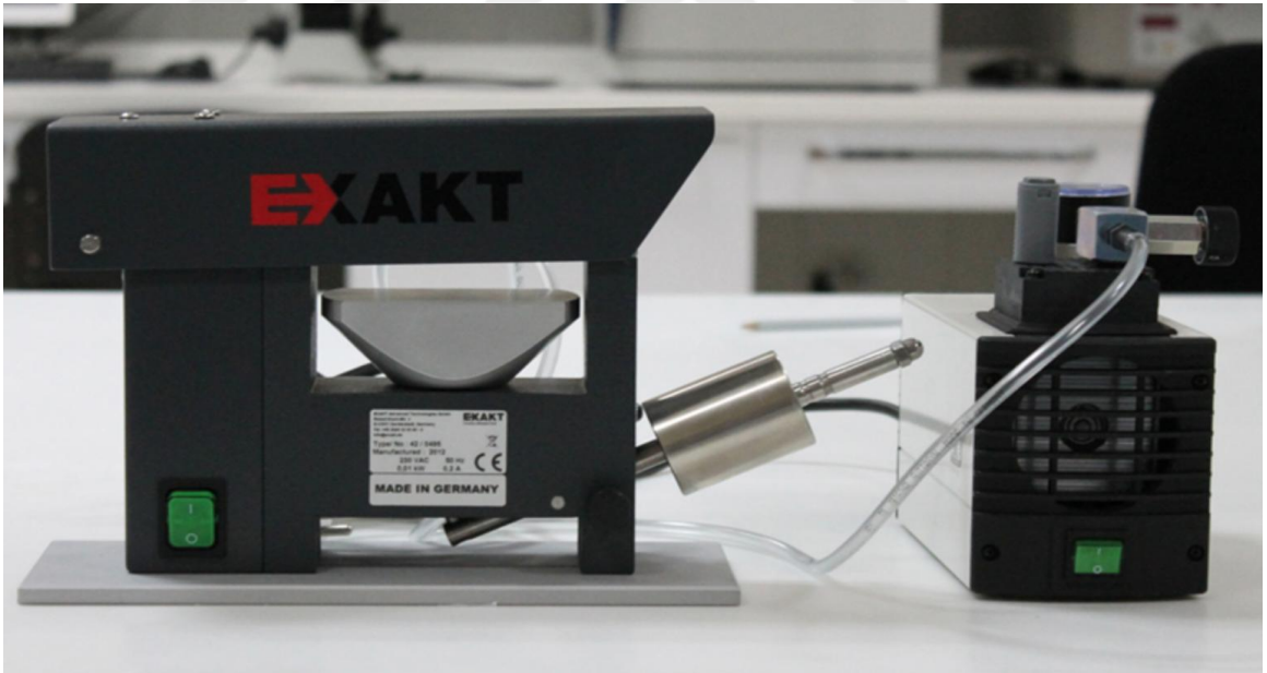
Şekil 3.9: Örnekleri içeren metil metakrilat rezin blokların lam üzerine vakum altında yapıştırılması
