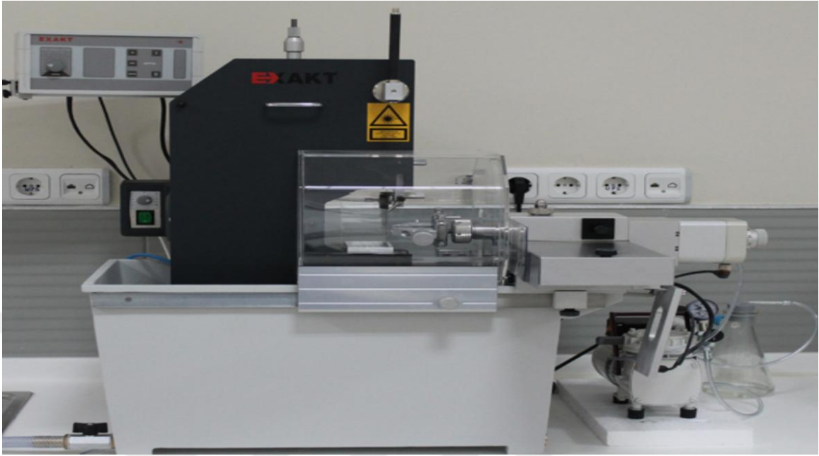
Şekil 3.10: Örneklerden kesit almak için kullanılan Exakt sert doku kesme cihazı
