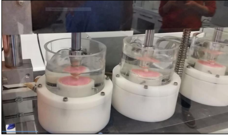
Şekil 3. 24: Örneklerin 50N Kuvvet Altında Yorulma Aşaması
