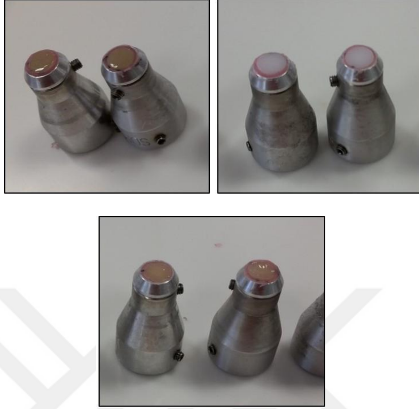
Şekil 3. 21: Porselenlerin Tutuculara Yerleştirilmesi
