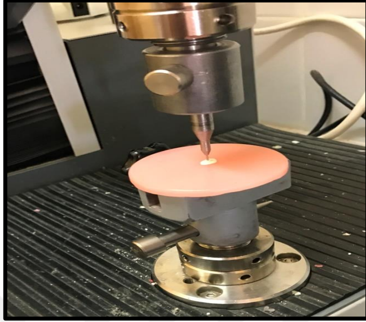
Şekil 3.7. Materyalin kanaldan uzaklaşması sırasında dirençle karşılaşmaması için kullanılan akrilik kalıp.
