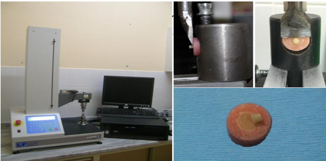
Şekil 3.20. Universal test cihazı ve makaslama testi
