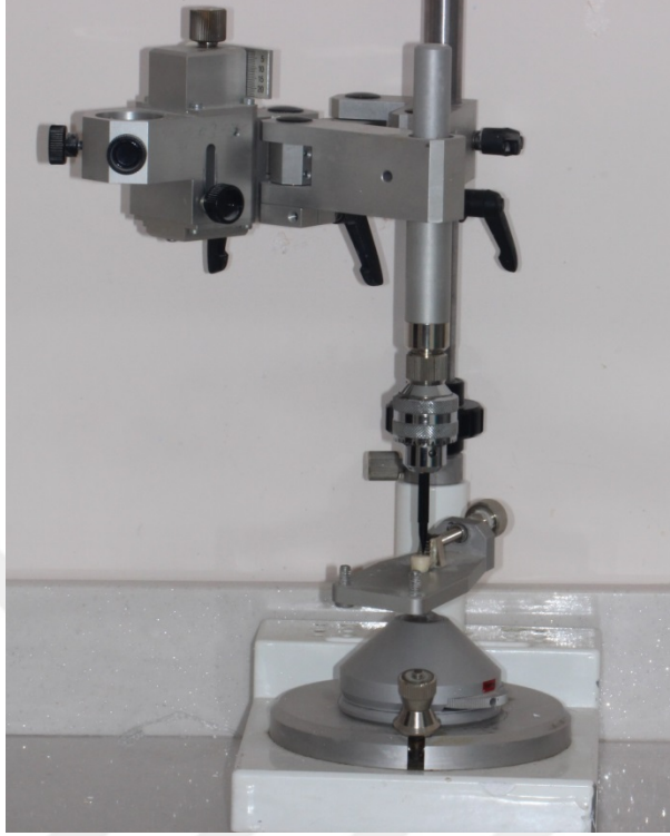
Şekil 3.5. Paralelometre cihazı ile dişlere kavite hazırlanması
