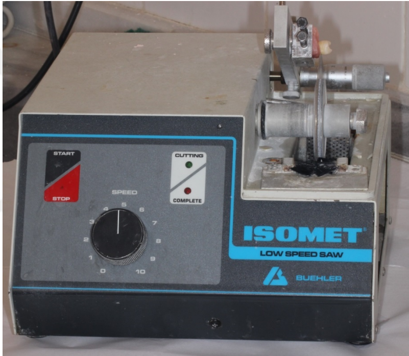
Şekil 3.4. İso met cihazıyla dişlerin okluzal aşındırma işlemi
