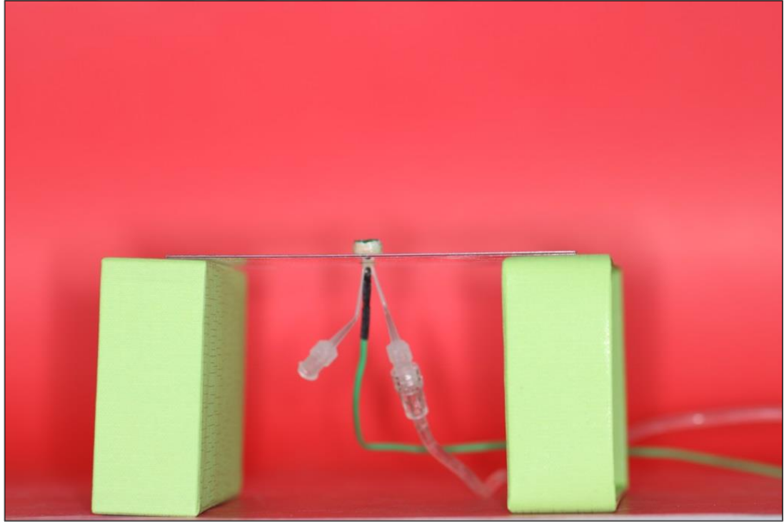
Şekil 3.12. Termokuplın yerleştirilmesi ve sıvı girişinin deney düzeneğinde gösterilmesi
