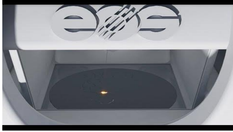
Şekil 2.9. DMLS Cihazının Üretim Haznesi (56)
