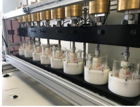
Şekil 3.16: Siklusların Yapıldığı Çiğneme Similatörü
