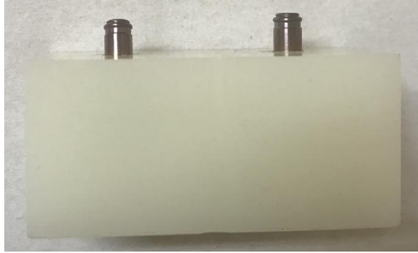
Şekil 3.7: Locator R-tx Dayanakların Yerleştirildiği Blokların Görünümü
