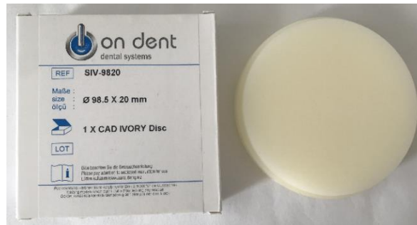
Şekil 3.1: Dikdörtgenler Prizması Şeklinde Blokların Elde Edileceği PMMA Disk
