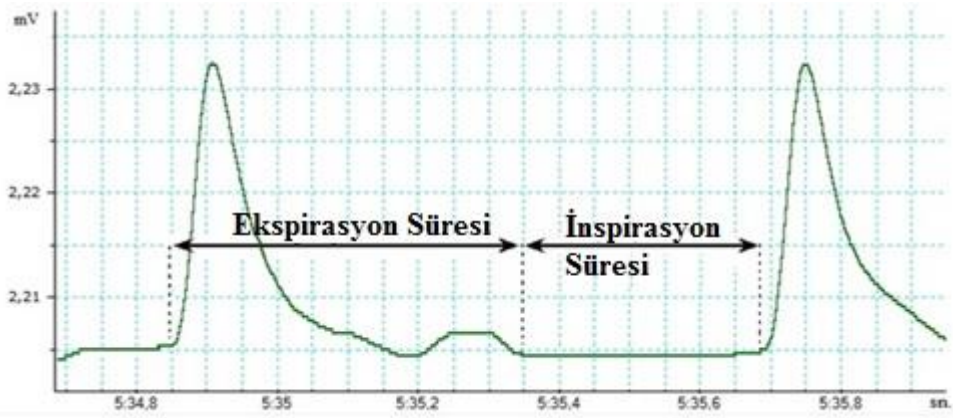
Şekil 5.2. Solunum sinyalinde ekspirasyon süresinin ve inspirasyon süresinin tespiti.
