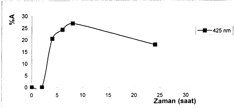
Şekil 9.9. 5.10^{-3} mol/L CrCl_3 içeren su örneğinde 400^{\circ}C 400 meshlik Kula volkanitinin zamana bağlı % Adsorpsiyon değişimi
