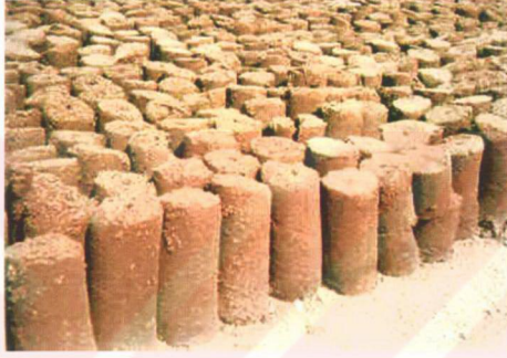
Şekil 6.1. Ekmek Fırınlarında Yakılmak Üzere Kalıplanmış ve Güneş Altında Kurutulmaya Bırakılmış Pirina [8]
