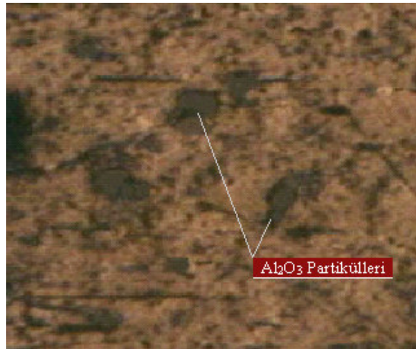
Şekil 4.7. AlSi12CuNiMg-Al 2 O 3 (%4) takviyeli malzemeye ait mikroyapı fotoğrafı (x100).
