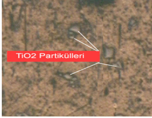
Şekil 4.11. AISi12CuNiMg-TiO 2 (%6) takviyeli malzemeye ait mikroyapı fotoğrafı (x100).
