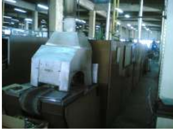
Şekil 5.8. Deneylerde kullanılan sinterleme fırını ( Tozmetal A.Ş. ).
