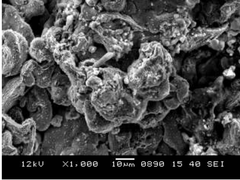
Şekil 5.66. Buharlanmış 17 numaralı parçanın sem'de 1000 kat büyütülmüş hali.
