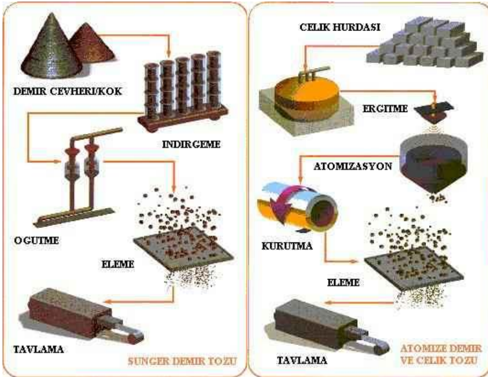
Şekil 3.4. a) İndirgeme ile demir tozu üretimi .....b) Atomizasyon ile demir ve çelik tozu üretimi (Sarıtaş. ve diğerleri, 1995).
