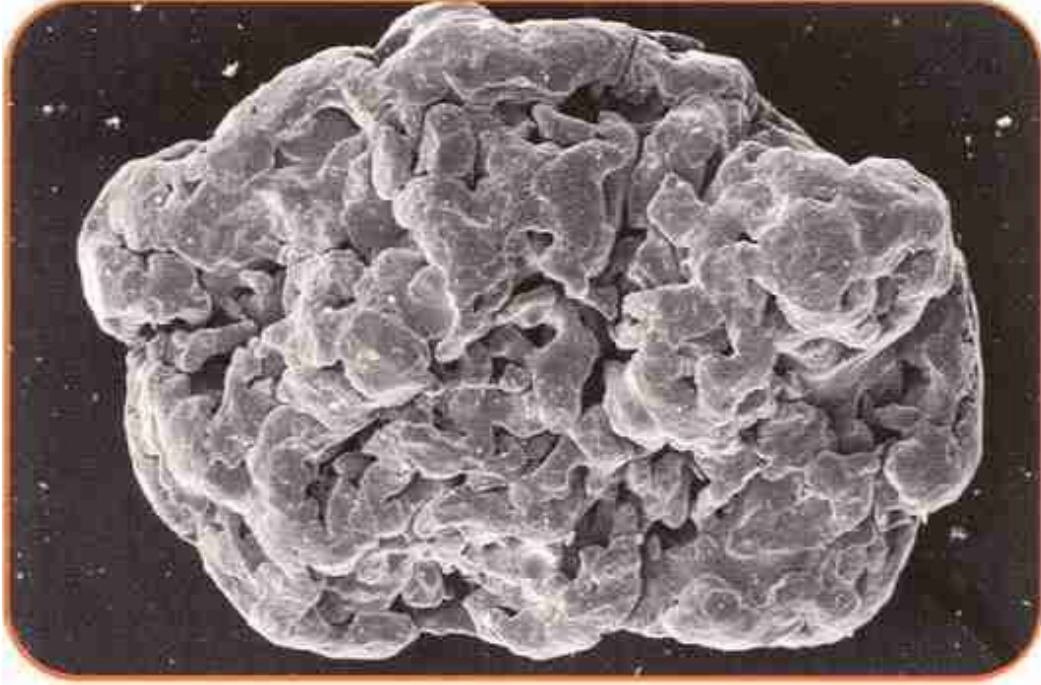
Şekil 3.5. İndirgenmiş "Sünger demir" tozu (Ersümer.1970; http://www.turktoz.gazi.edu.tr/ttmd_tr.htm ).
