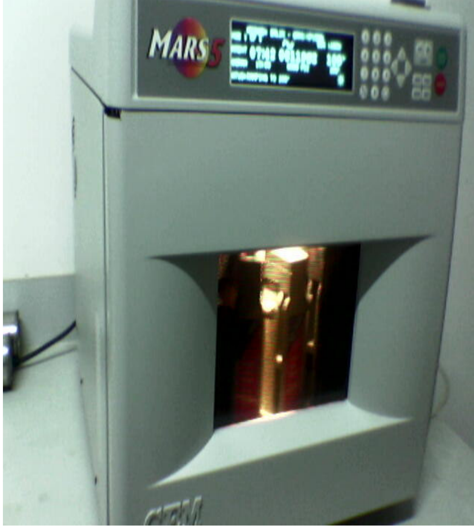
Őekil 2.5.1.1: CEM Mars - 5 ESP 1500 PLUS Mikrodalga Őrnek Hazırlama Cihazı.
