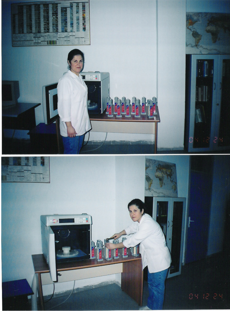
Şekil 2.7.2.2: Hazırlanan örneklerin mikrodalga örnek hazırlama cihazına yerleştirilmesi.
