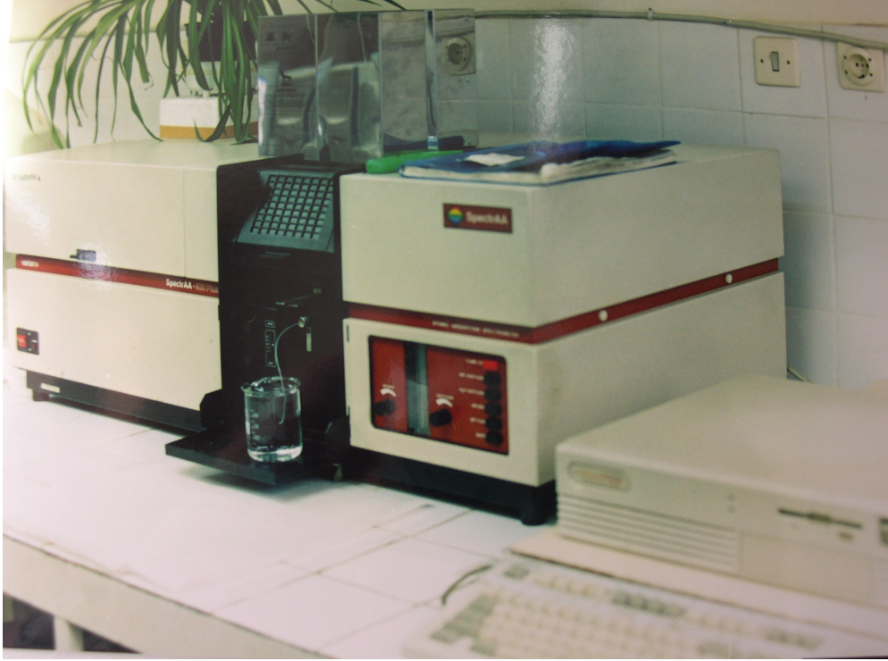
Şekil 2.7.1.2: Varian SpectrAA 400 Plus Atomik Absorbsiyon Alev Spektrometresinin genel görünüşü.
