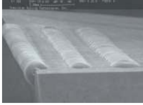
Şekil 5.11. 420SS kalıp malzemesinin lazer kaynağı ile tamir edilmesi (Kwiatkowski, Kwiatkowski;2003).
