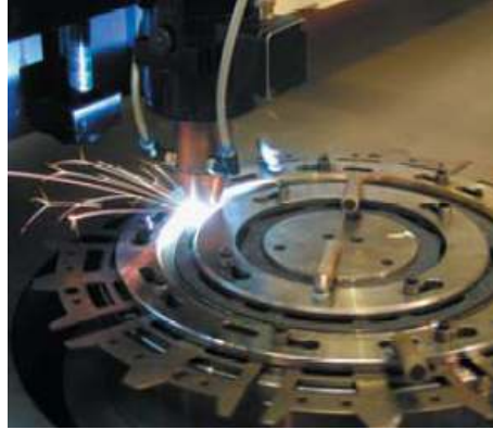
Şekil 5.10. Araçlardaki debriyaj balatalarının lazer kaynağı işlemi (109).
