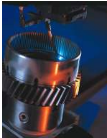
Şekil 5.7. Lazer kaynağı uygulaması (Brunner, 2003).
