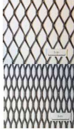
Şekil 2.21. Güçlendirme için kullanılan çelik hasır örnekleri [6]
