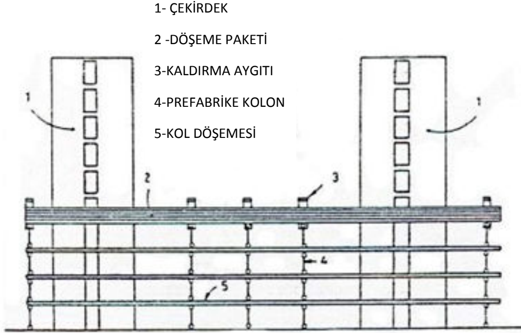
Şekil4.7 Kaldırılan Döşemeli ve Perdeli Sistemler
