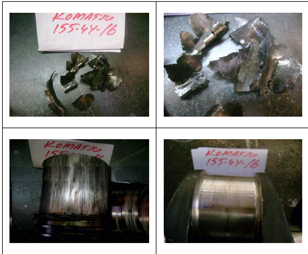
Şekil 5.11 289 nolu Komatsu dozerin motorunda oluşan hasar
