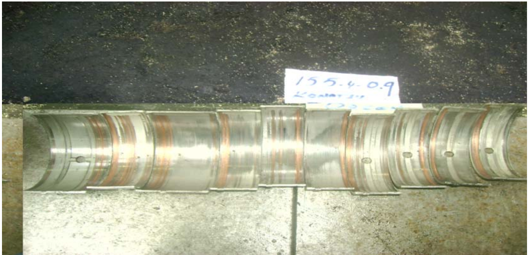
Şekil 5.6 Motor söküldüğünde yatakların durumu
