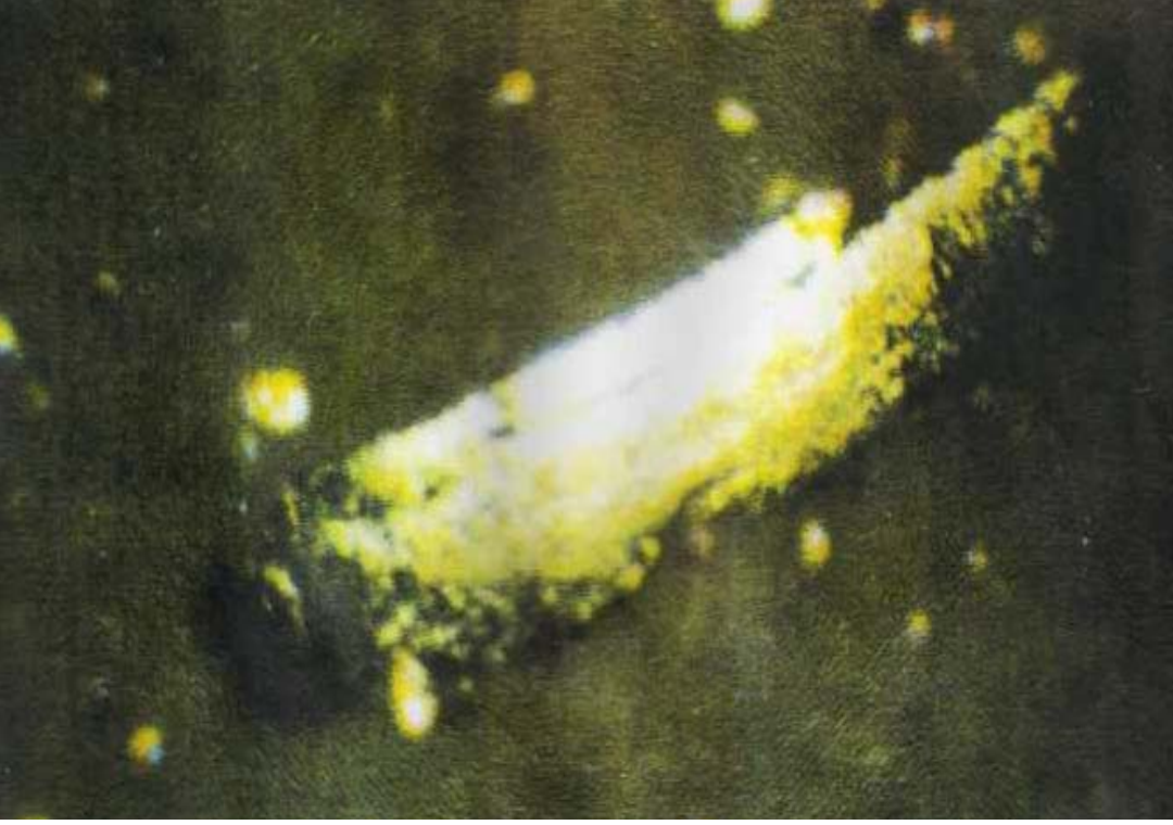
Şekil 3.4 Dişli yorulması ile oluşan parçacık, 500 \mu\text{m}
