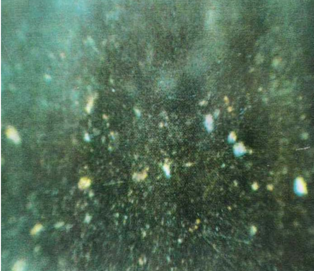
Şekil 3.7 Fretting aşınma parçacığı, hepsi 5 \mu\text{m} ' den küçük
