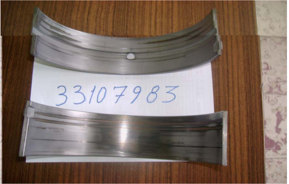
Şekil 5.9 Aşınmış kol yatağı görüntüsü.
