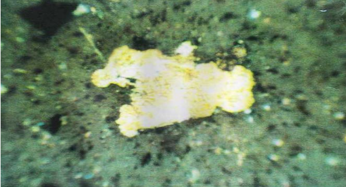
Şekil 3.10 Bronz aşınmış parçacığı, 280 \mu\text{m}
