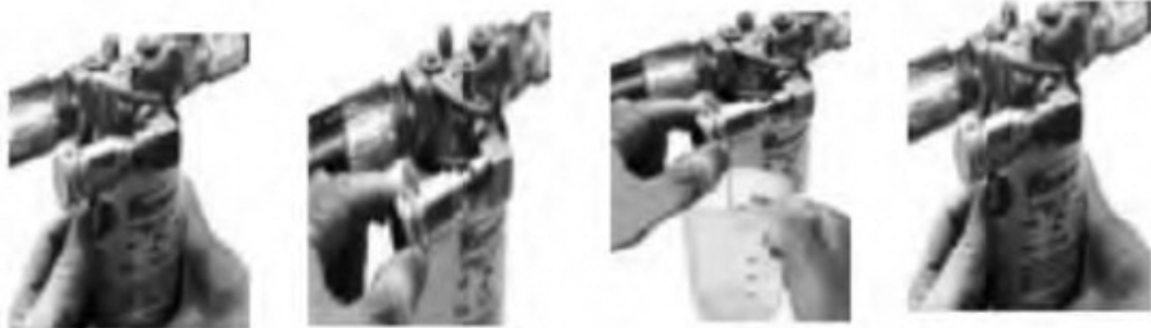
Şekil 2.7 Örnekleme valflerinden yağ örneğinin toplanma prosedürü (Hydra-Check Valfleri)
