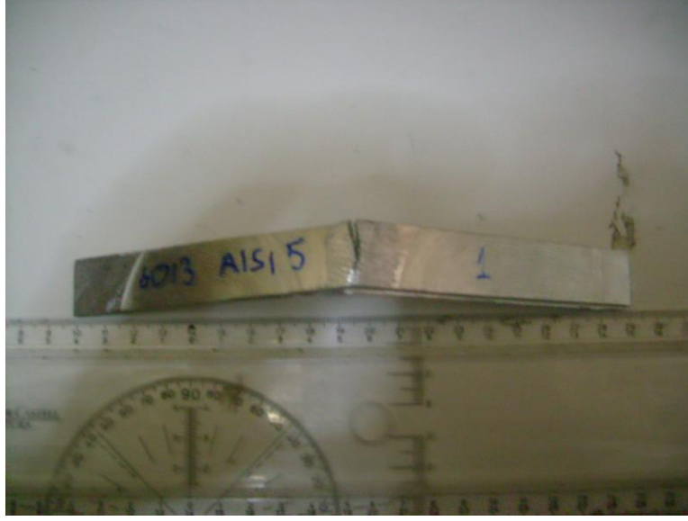
Şekil 5.43. 6013-AISI5 (5 numaralı) Numunede Çatlak
