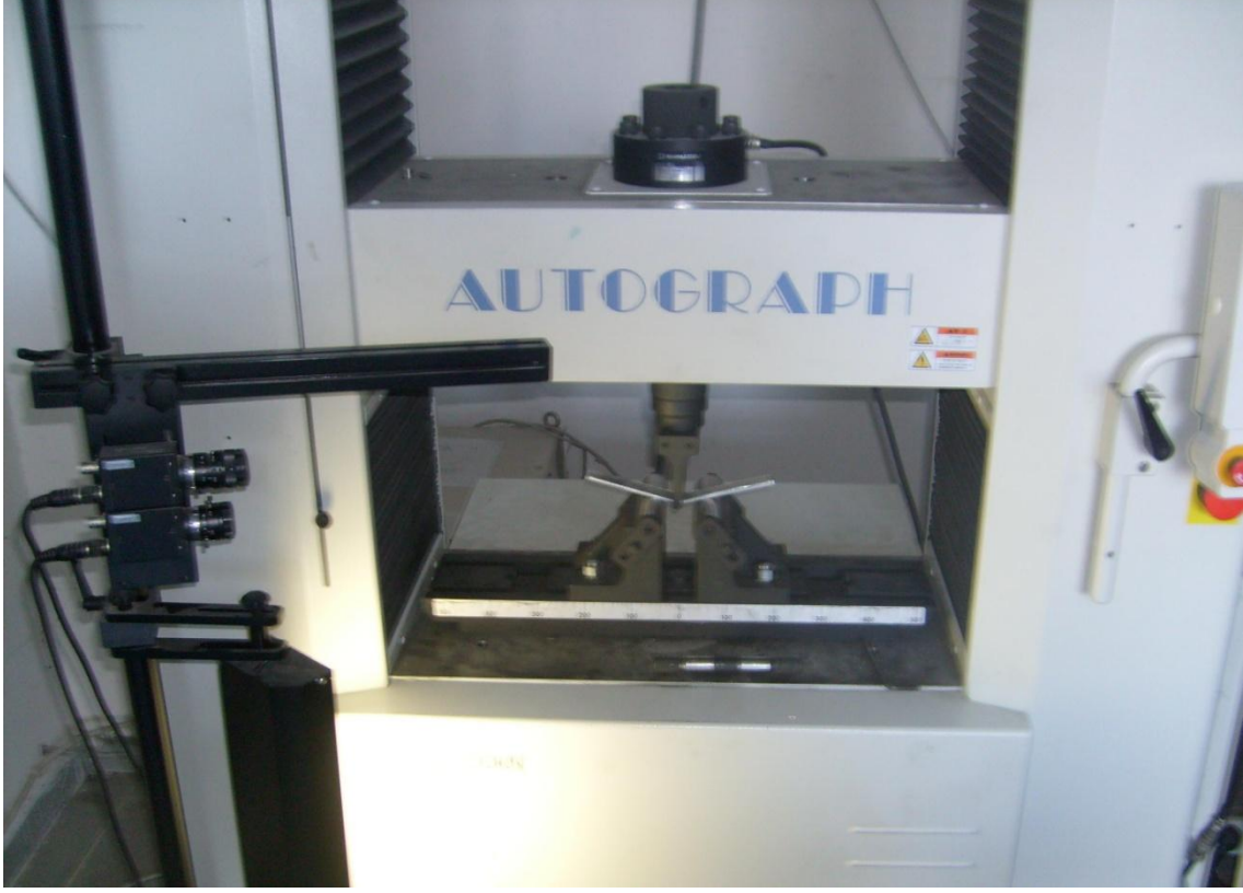
Şekil 5.7. Eğme Deneyinde Kullanılan Eğme Deney Cihazı
