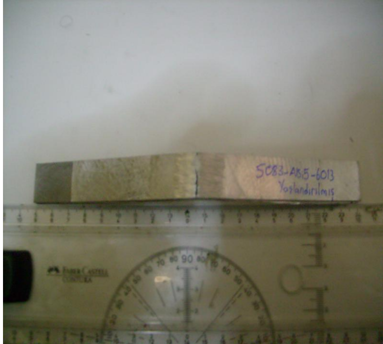
Şekil 6.49. Yaşlandırılmış 5083-AISI5-6013 ( 15 Numaralı ) Numunede Çatlak
