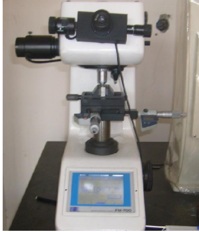
Şekil 5.4. Kullanılan Mikro Sertlik Ölçme Cihazı
