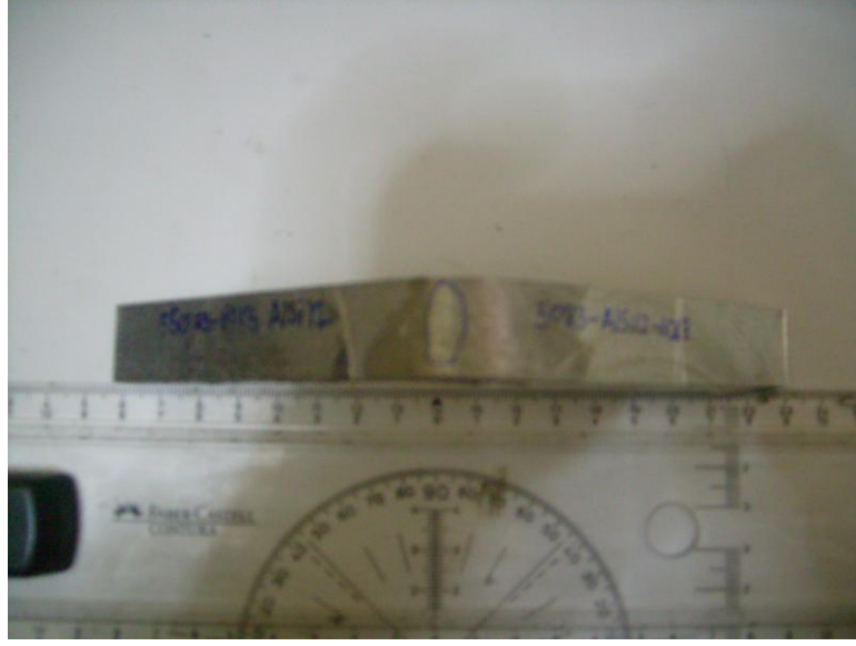
Şekil 6.46. 5083-AISI12-6013 (11 Numaralı) Numunede Çatlak
