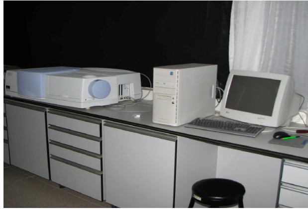
Şekil 6.5. Celal Bayar Üniversitesi Lüminesans Araştırma Laboratuvarında bulunan Perkin Elmer Lambda 950 UV/VIS/NIR Spektrofotometre Sistemi
