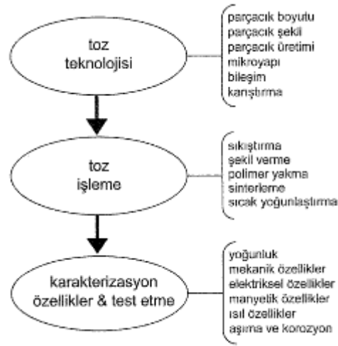
Şekil 2.2 Toz metalurjisi yönteminde parça üretim iş akış adımları [13].
