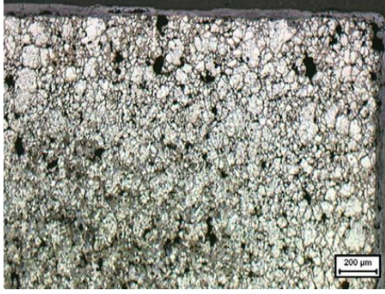
Şekil 3.14 Numune yüzeyindeki dekarbürize olmuş tabaka
