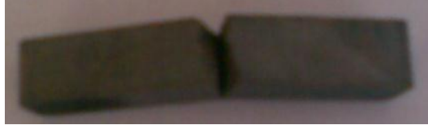
Şekil 3.24 Üç noktadan eğme deneyi ile kırılan numune
