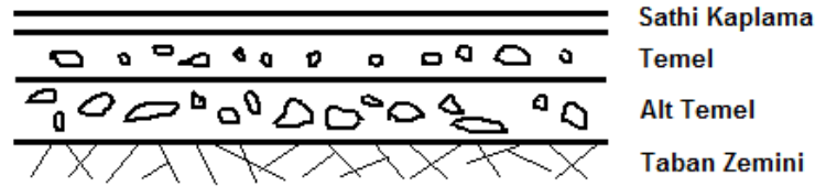
Şekil 3.1. Sathi Kaplama Enkesiti
