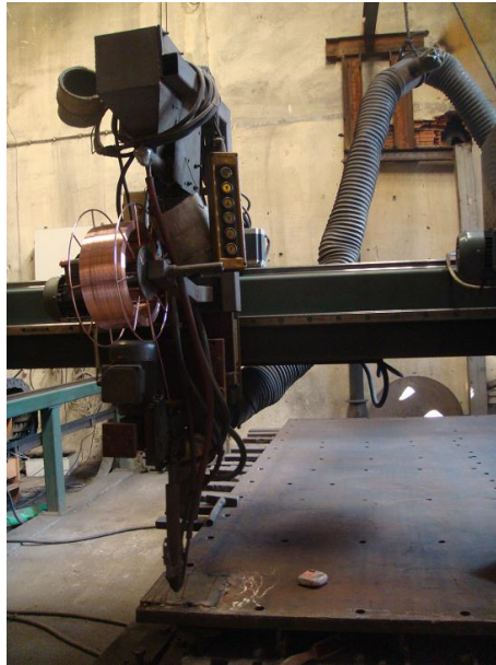
Şekil 5.9. Aşınma plakalarının üretiminde kullanılan kaynak donanımı
