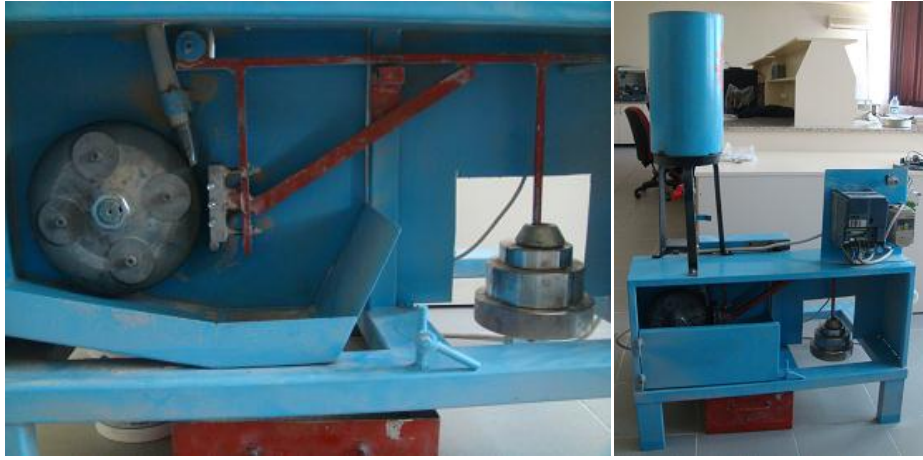
Şekil 5.70. Aşınma testlerinin yapıldığı kuru kum/kauçuk tekerlek abrazyon test cihazı
