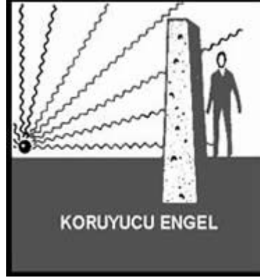
Şekil 2.13: Radyasyona karşı zırhlamanın etkisi
