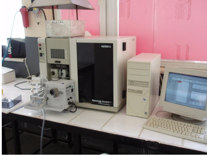
Şekil 4.1 Arsenik analizinin yapıldığı atomik absorpsiyon spektrometresi ve sürekli akış hidrür sistemi
